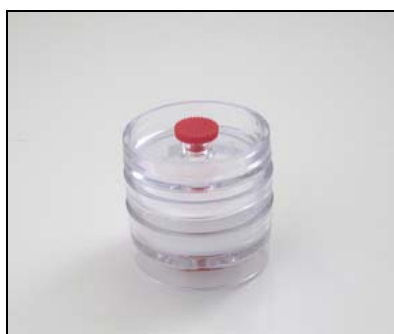
Figur 2. För provtagning av trikloramin – kvartsfiberfilter monterade i en filterkassett.
