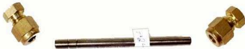
Figur 3. För provtagning av THM – multiadsorbentrör Carbotrap TM 300 av rostfritt stål med tillhörande metallskruvar för förslutning.
