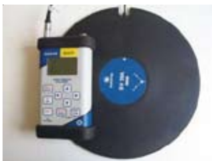
Svan 948 är en bärbar robust digital 4-kanals vibrationsanalysator för mätning av hel- och delkroppsvibrationer. Instrumentet kan hyras från instrumentpoolen.
